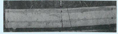
▲ FA-R工法の荷重試験 荷重約41.4kNで曲げひび割れ発生すると一時的に耐力低下するが荷重は再び上昇し42.9kNに達した。
